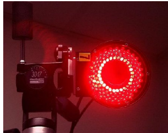
Figura 12: sistema de captura com os LEDs acesos em torno da lente de entrada da câmera, retroiluminada (Vicon).
