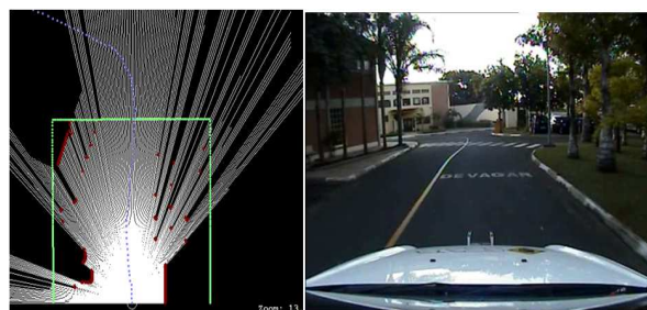
Figura 20: Dados sensoriais coletados com o veículo real Laser + GPS + câmera
