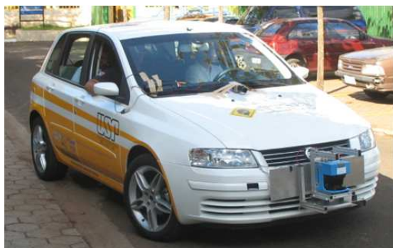
Figura 19: Veículo real equipado com sensores e atuadores
